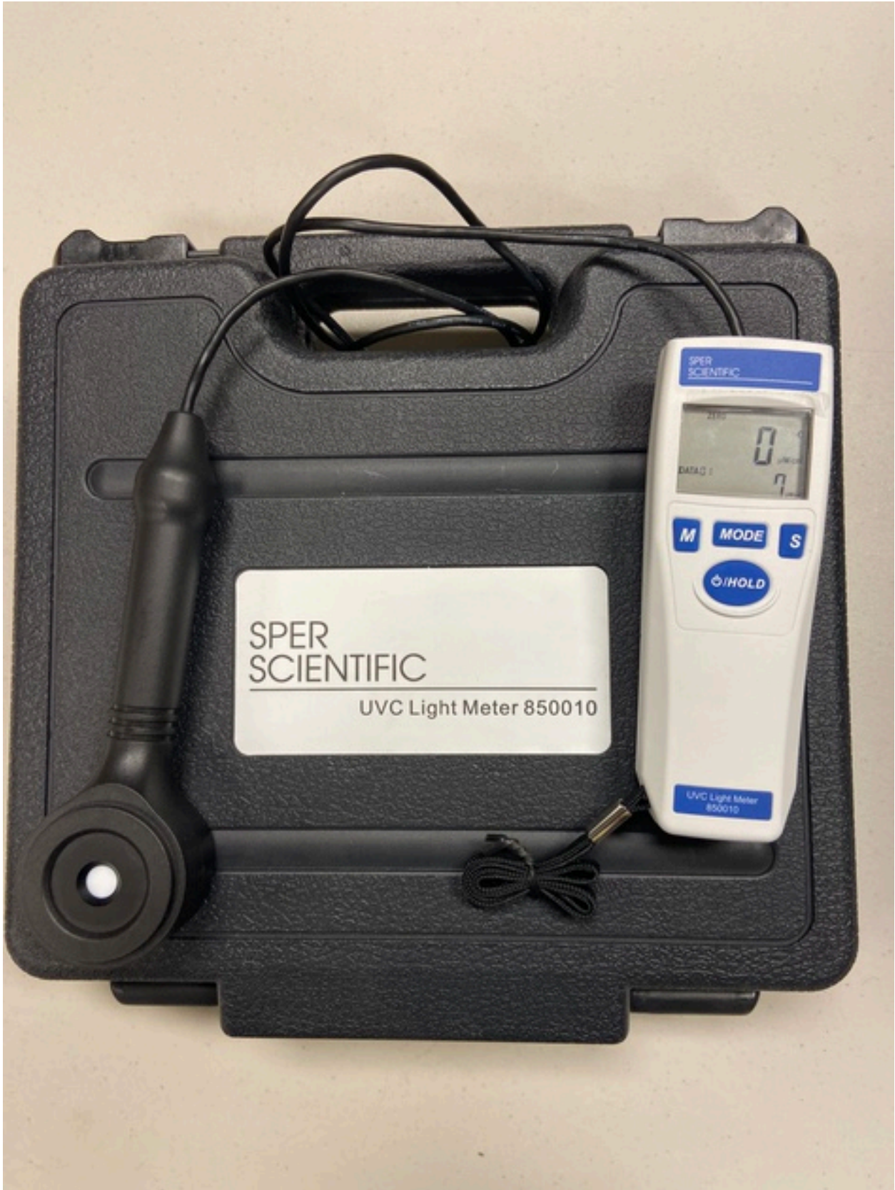
Fig. 4 UV-C light meter 1
